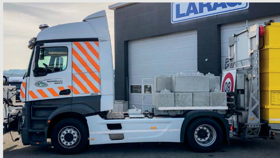
SwissBlock®-TEC kraftschlüssig mit Fahrgestell verschraubt.
